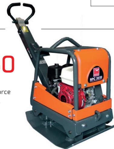
Plaques vibrantes réversibles hydrauliques compactes avec forces de compactage de 30 à 65 kN. La vitesse et la profondeur de compactage sont ajustées via l'actionnement hydraulique de l'élément excentrique. Cela permet un mouvement fluide de la plaque et la rend facile à l'utilisation et la manipulation. Plaque polyvalente pour travaux de compactage près des poteaux et plots en béton. Idéale lors de travaux de remplissage de sols, fondations ou réparations des routes.
